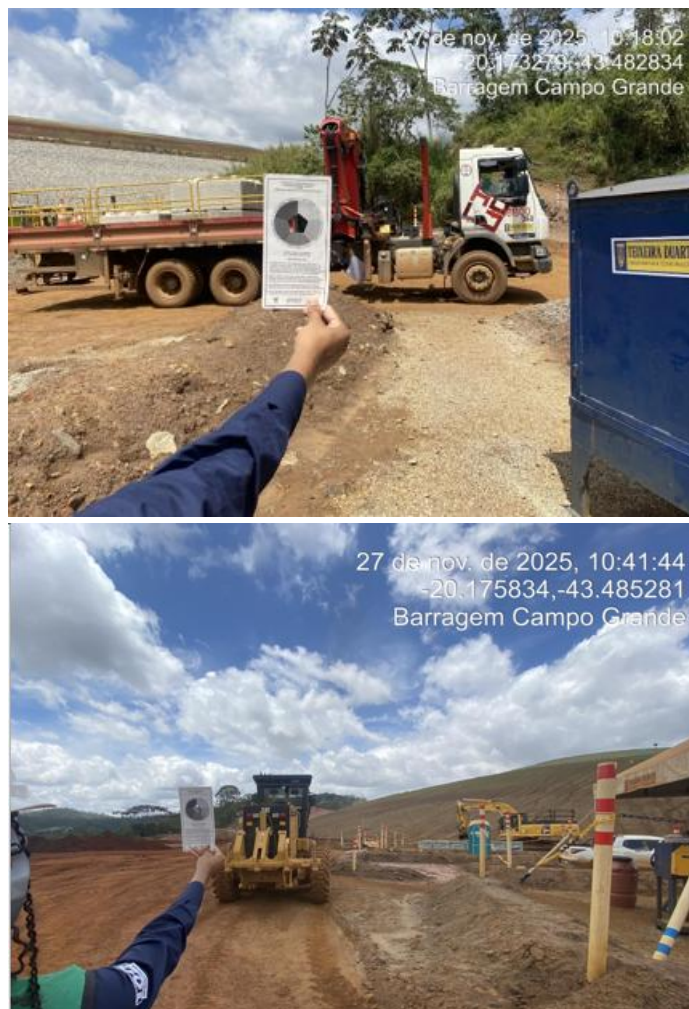
Figura 42 - Registro fotográfico do Monitoramento de emissões atmosféricas utilizando-se a escala Ringelmann para o mês de novembro/2025.
