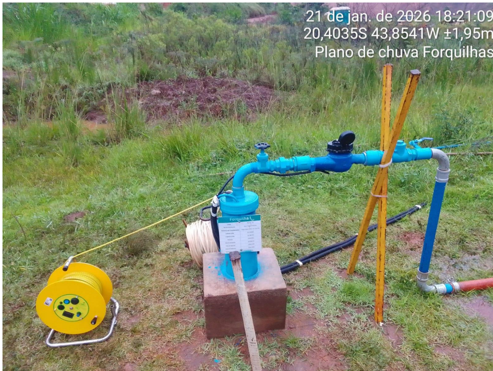
Figura 18 - Teste de bombeamento Forquilha I (janeiro/26)
