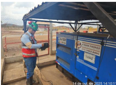
Figura 51 – Teste de opacidade em gerador. Fonte: Vale, outubro de 2025.
