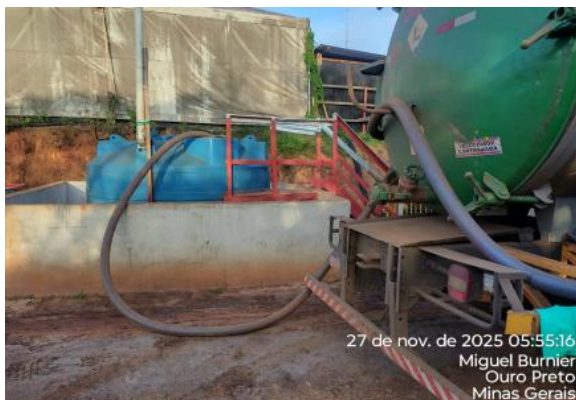
Figura 85 - Recolhimento de efluentes do tanque localizado no Pátio da Oficina de Forquilhas I/II. Fonte: Vale, novembro de 2025.
