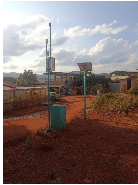
Figura 35 - Estação de Monitoramento de Ruído de Mota. Vale, 2023.
