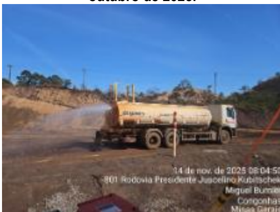
Figura 43 - Caminhão pipa realizando aspersão das vias. Fonte: Vale, novembro de 2025.
