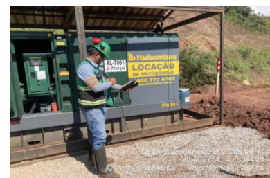
Figura 53 - Teste de opacidade em uma motobomba. Fonte: Vale, dezembro de 2025.
