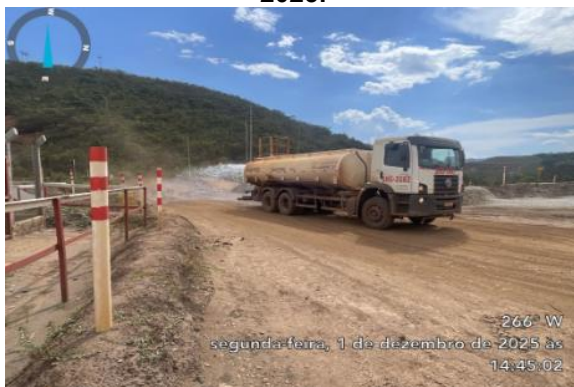
Figura 45 - Umectação nas vias de Forquilhas. Fonte: Vale, dezembro de 2025.
