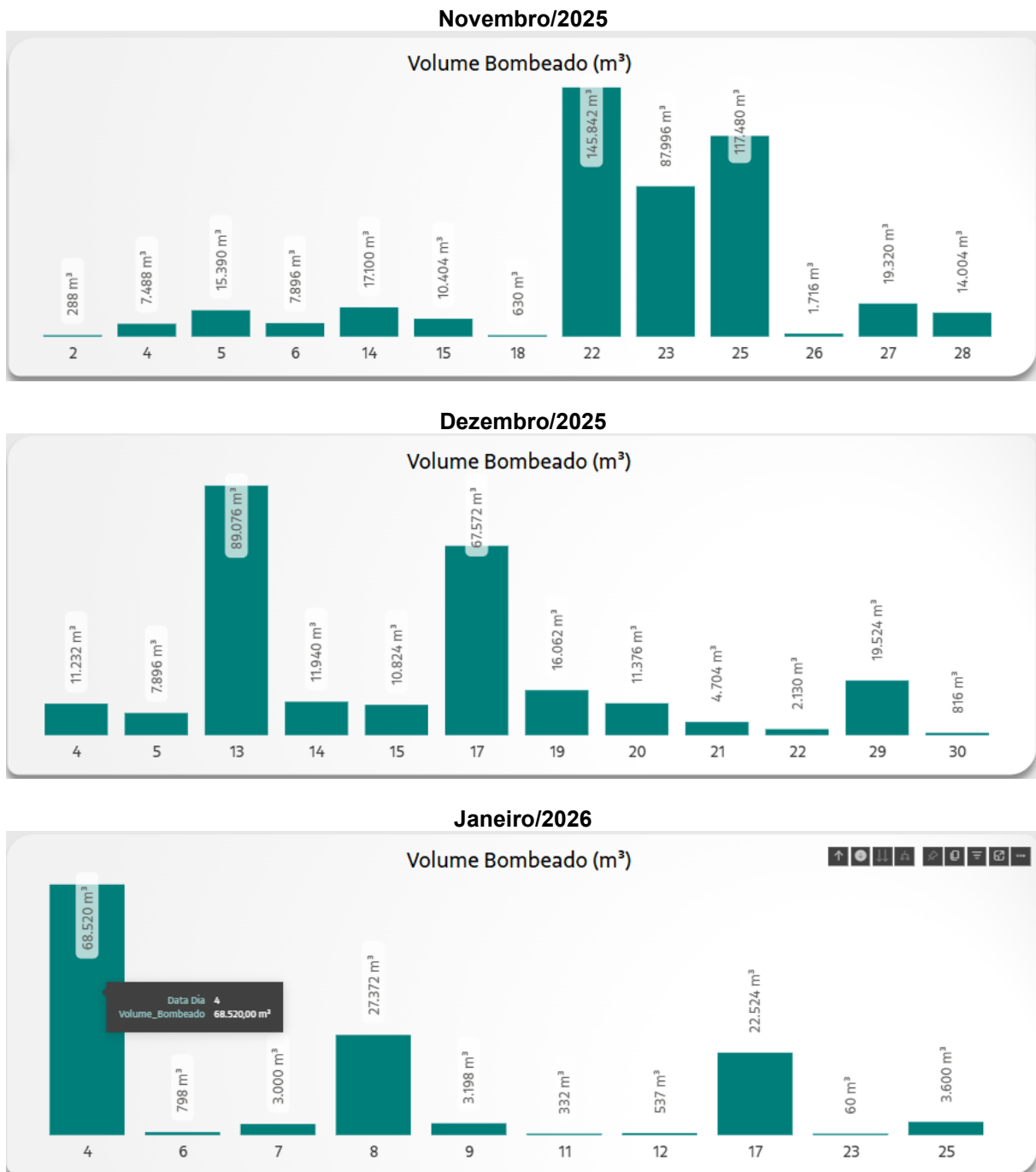
Figura 98 – Volume total bombeado da diariamente nas barragens Forquilha I e II, considerando a somatória de todos os sumps.
