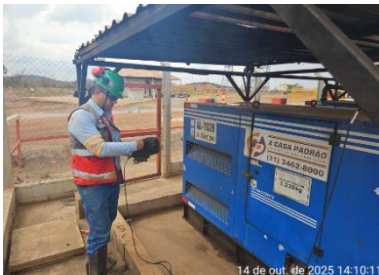
Figura 44 – Teste de opacidade em gerador. Fonte: Vale, outubro de 2025.
