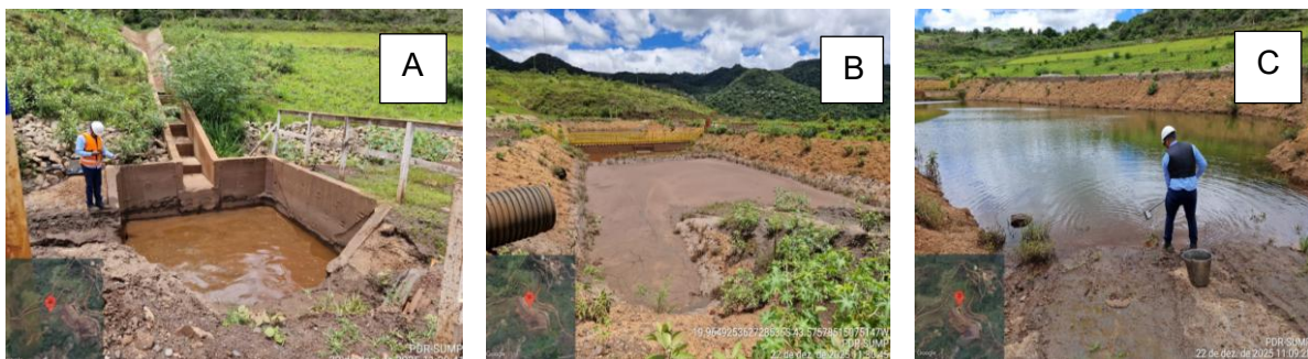
Figura 68 – Observa-se na Imagem (A) que o sump apresenta aspecto turvo, enquanto na Imagem (C), após o tratamento, a água encontra-se límpida, indicando a eficiência do controle de turbidez.
