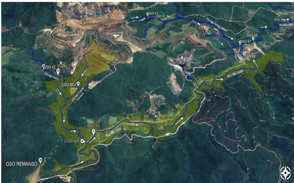
Figura 61 - Mapa da rede de monitoramento do parâmetro turbidez para a obra de descaracterização da barragem Sul Superior. A área indicada na cor “verde” indica os locais de Zona de Autosalvamento da Barragem Sul Superior.
