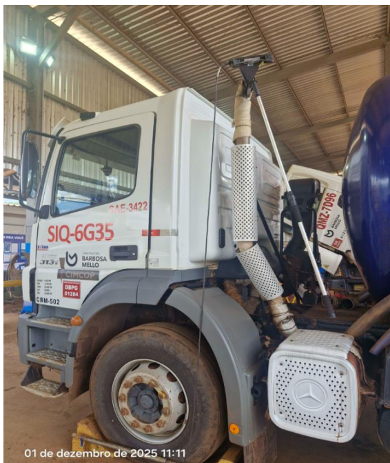
Figura 42 - Monitoramento de Fumaça Preta com o uso do Opacímetro.
