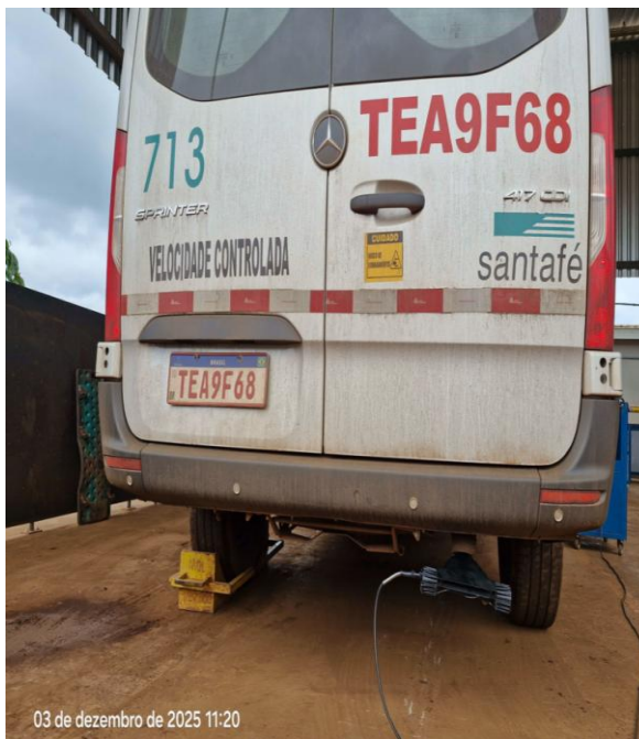
Figura 43 - Monitoramento de Fumaça Preta com o uso do Opacímetro.
