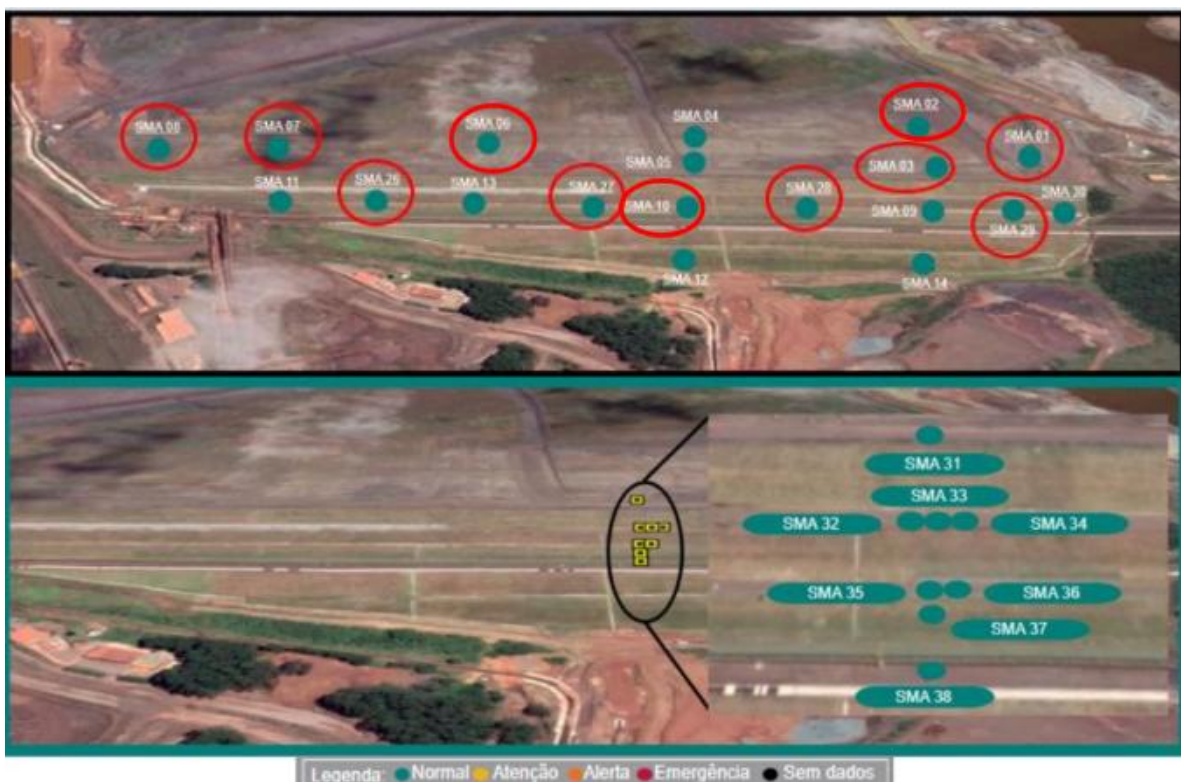
Figura 105 - Painel de monitoramento dos sismógrafos Barragem Vargem Grande e planta de localização dos sismógrafos de superfície. Os sismógrafos circulosados de vermelho foram desmobilizados em março e em julho/2025. Fonte: CMG (VALE, 2026).
