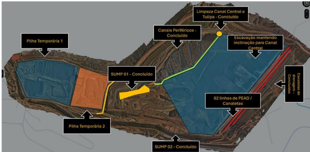
Figura 21 - Visão das obras de melhorias na estrutura, concluído.
