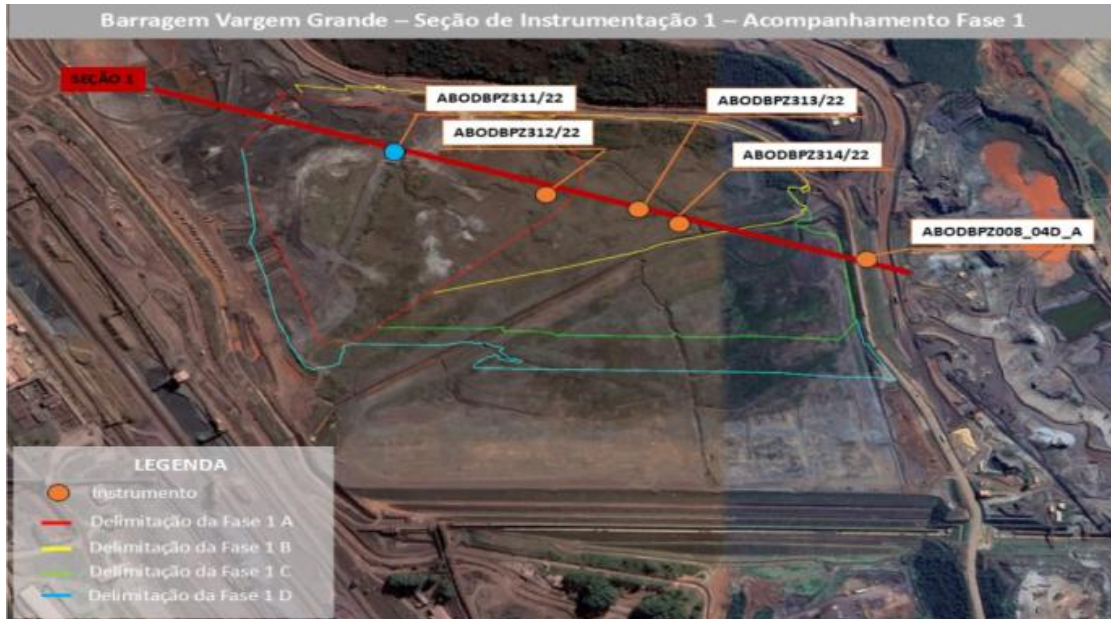
Figura 11 – Instrumentação do nível da freática no reservatório.
