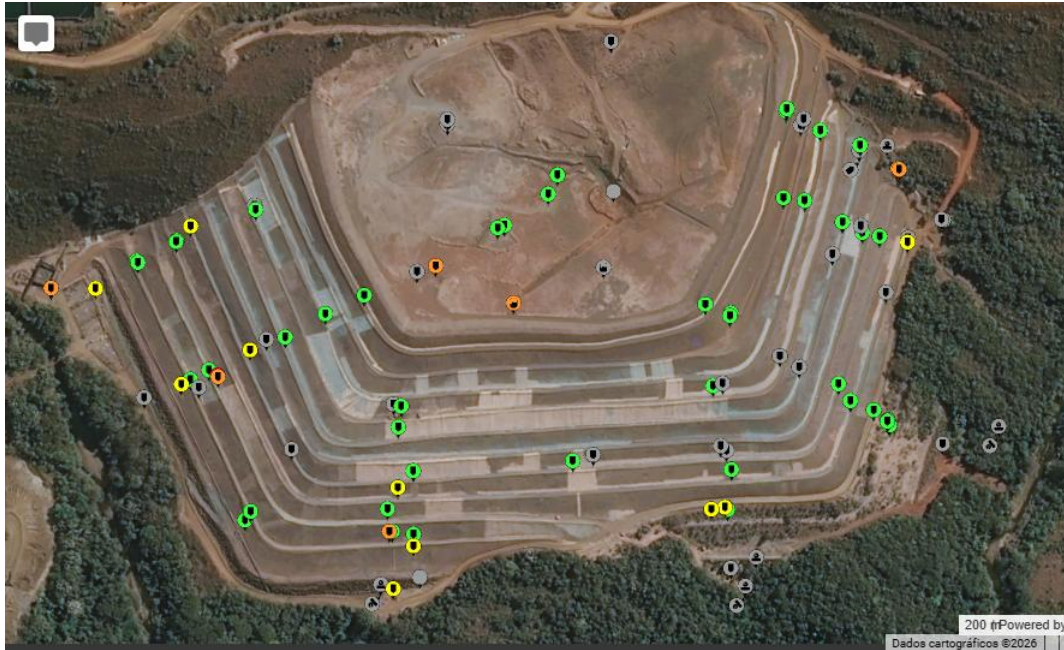
Figura 24 – Mapa de instrumentação da Barragem Xingu. Fonte: SHMS, 2026.
