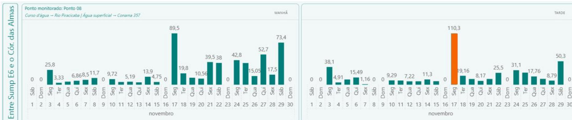
Figura 65 - Resultados dos monitoramentos diários de turbidez – jusante da obra PT 08 - novembro/2025. Fonte: Vale, 2025.
