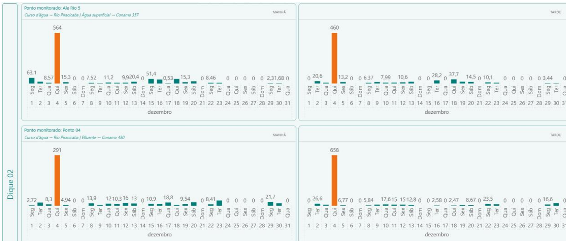
Figura 62 - Resultados dos monitoramentos diários de turbidez – lançamento de efluente (PT 04) e a jusante da obra (ALE-RIO-05) – dezembro/2025. Fonte: Vale, 2025.
