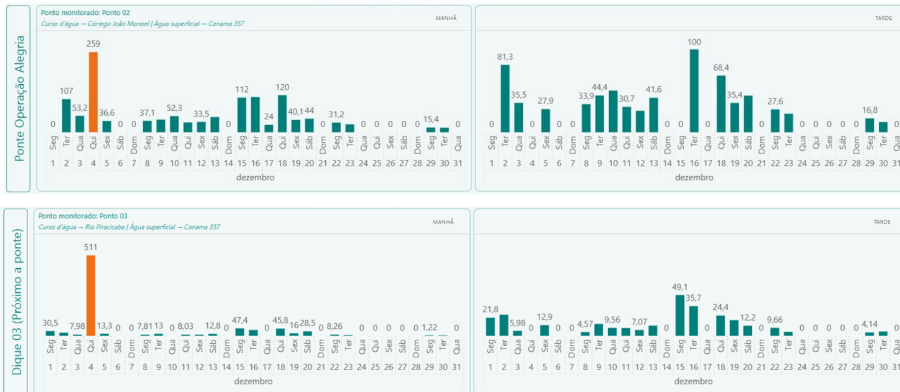
Figura 60 - Resultados dos monitoramentos diários de turbidez a montante da obra- dezembro/2025. Fonte: Vale, 2025.
